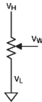
Рис. 1 Трехвыводная конфигурация потенциометра
