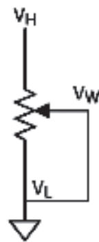
Рис. 2 Двухвыводная конфигурация переменного резистора
