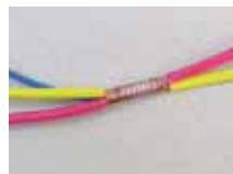
Установка Zeta 633 SP – это первая машина для автоматического производства спарок проводов путем их ультразвуковой сварки. Ее отличает рентабельность производства при стабильно высоком качестве сварки. В основе станка лежит технология Zeta 633, и он предлагает разнообразные возможности для работы с уплотнителями и контактами.
