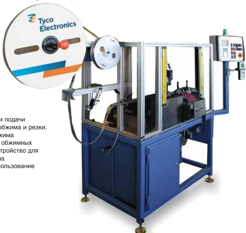
Оборудование сочетает функции подачи контактов, обрезания провода, обжима и резки. Встроенный монитор усилия обжима обеспечивает высокое качество обжимных соединений. Дополнительное устройство для обрезки некачественного обжима предотвращает дальнейшее использование поврежденных цепей.
