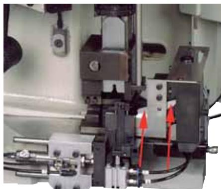
Когда монитор контроля качества (CQM) определяет некачественный обжим, блок DCC обрезает неисправный наконечник. Провод будет обрезан рядом с наконечником.
