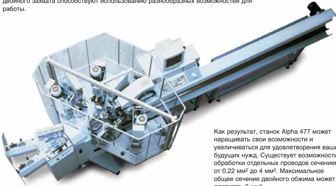
Как результат, станок Alpha 477 может наращивать свои возможности и увеличиваться для удовлетворения ваших будущих нужд. Существует возможность обработки отдельных проводов сечением от 0,22 мм<sup>2</sup> до 4 мм<sup>2</sup>. Максимальное общее сечение двойного обжима может достигать 6 мм<sup>2</sup>.
