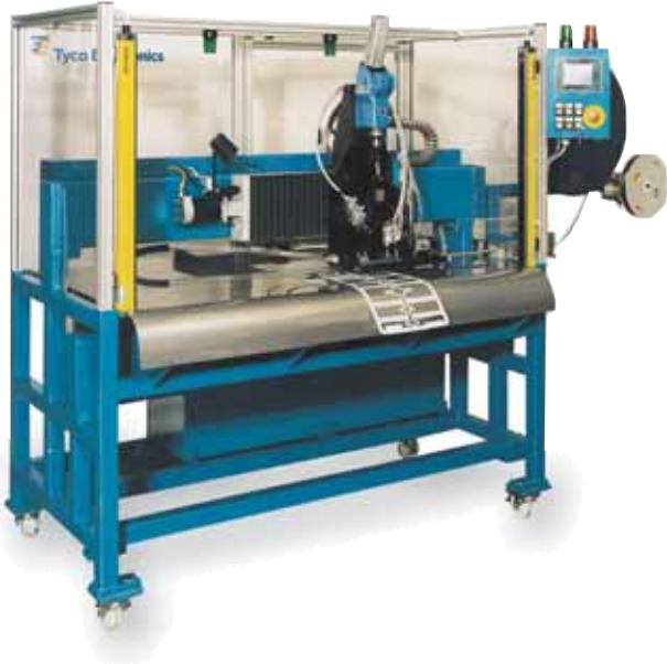
Готовый к запрессовке контакт обрезается от края ленты, вставляется в плату и обжимается с гибким печатным датчиком. Несколько контактов формируют соединение между датчиком и платой. Сила, требуемая для запрессовки контакта ACTION PIN с печатной платой, контролируется датчиком усилия.
