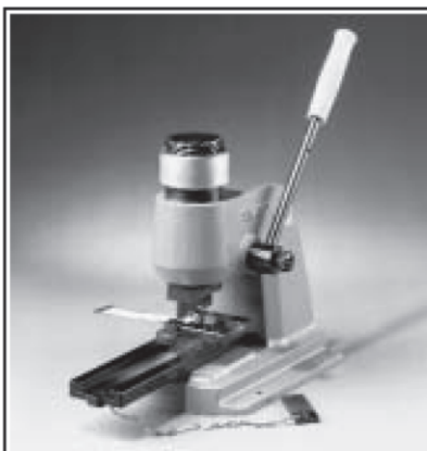
Настольный пресс (каталожный номер 733280-3). Полный комплект оборудования, включая специализированный инструментальный набор Micro-MaTch, используемый с настольным прессом 654173-2.
