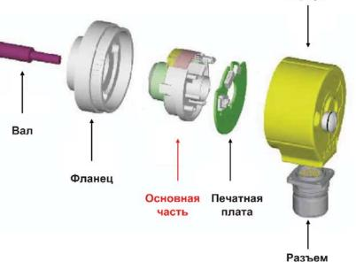
Выбор модификации энкодера — с зажимным фланцем, сервофланцем, полым тупиковым валом или сквозным полым валом, для различного диаметра вала, абсолютный или инкрементальный с любым разрешением — теперь никак не влияет на срок производства и поставки.
