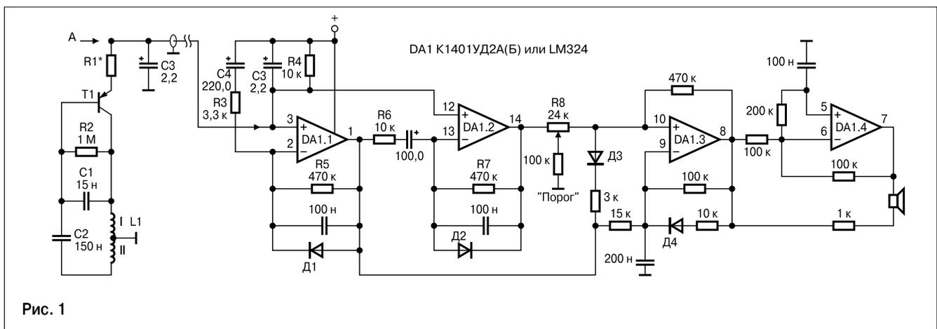
ски любым структуры р–п–р, даже германиевым с малым усилением. Конденсатор С1 желательнее будет подобрать с емкостью в пределах 5–20 нФ по максимальной чувствительности контура. Иногда хороший результат бывает при подключении С1 не к обмотке II, которая является базовой, а к общему проводу. Катушка контура имеет диаметр 14–16 мм, на ней намотано 260 витков провода диаметром 0,2–0,5 мм с отводом от сто шестидесятого витка.
