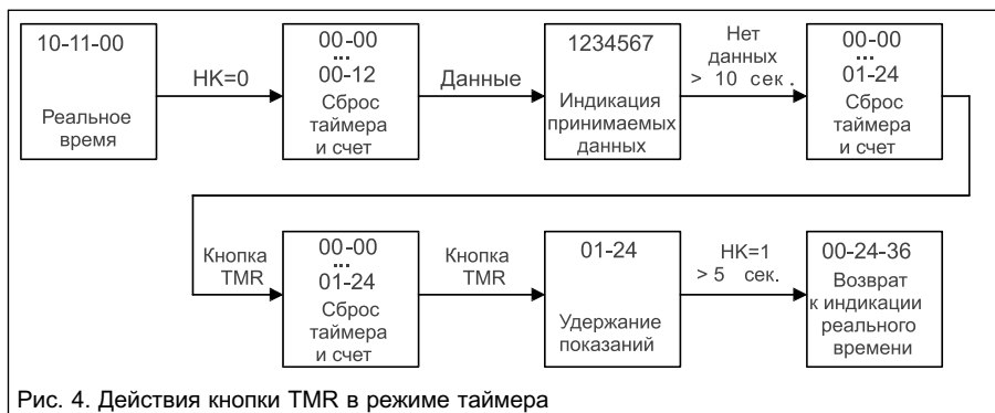
Рис. 4. Действия кнопки TMR в режиме таймера
