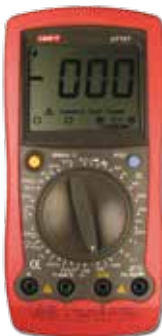
UT101 Цифровой мультиметр со счетчиком числа оборотов
