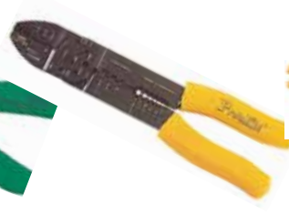
Кримпер для изол. клемм 1.5, 2.5, 6 мм 2 , неизол. клемм 1.5, 2.5, 4.5 мм 2 , стриппер 0.75 – 6 мм 2 , съемник болтов M2.5-M5
