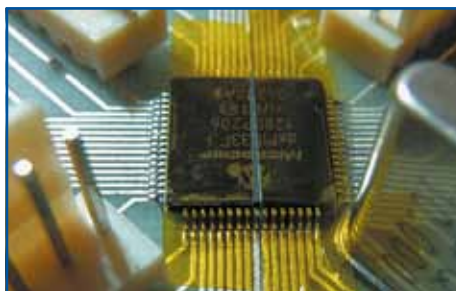
Рис. 2. Защита чувствительных компонентов при пайке
