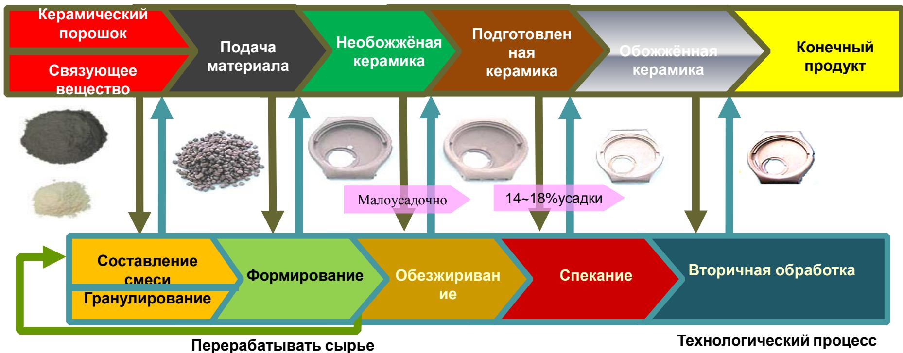
Литье под давлением — это альтернативный процесс формования, который включает (1) нагрев загрузки термопластичного материала до постоянного состояния текучести, (2) перемещение его под давлением через каналы в замкнутое пространство, а затем (3) охлаждение для получения твердой детали **с максимально возможной степенью однородности**.
